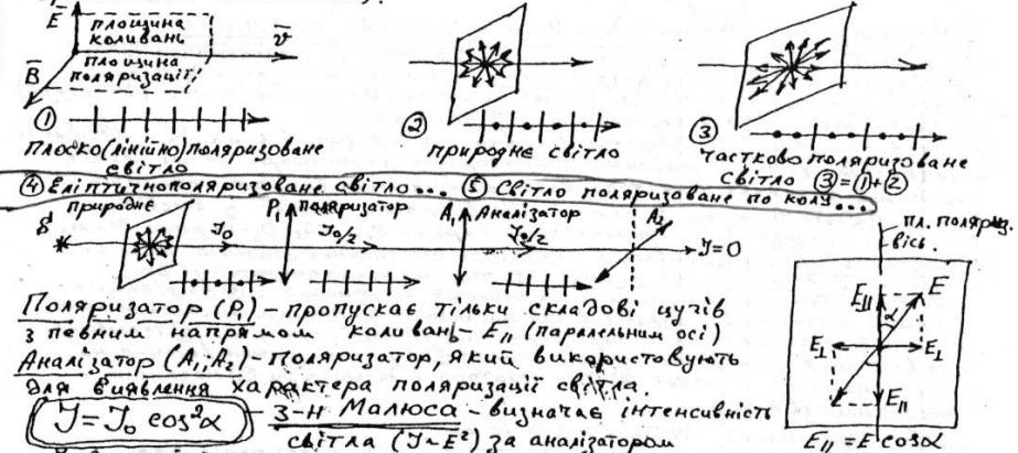
Поляризатор ( $P$ ) - пропускає тільки складові цугів з певним напрямком коливань  $E_{\parallel}$  (паралельним осі)
