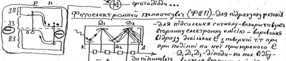
Фотоделектронний гальваноскоп (ФДП) - для підрахунку рогонів - для підвищення сигналу - використовують вторинну електронну емісію - виробляючи відродж десількох е-з поверхні т.т. при подінні на неї притисканого С. Д. десількох - іоніді - на них відбувається вторинна емісія
